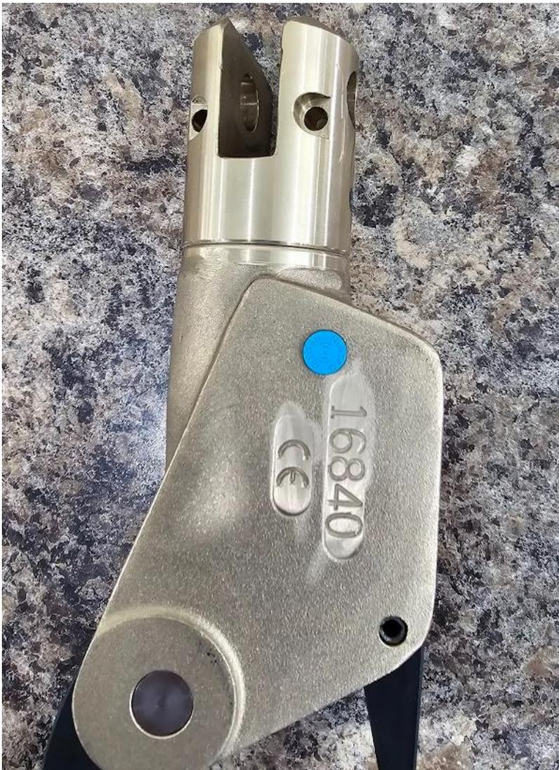
B. Coloque un conjunto de gancho CBL-3L sobre una superficie plana con el disco RFID hacia arriba como se muestra a continuación:
